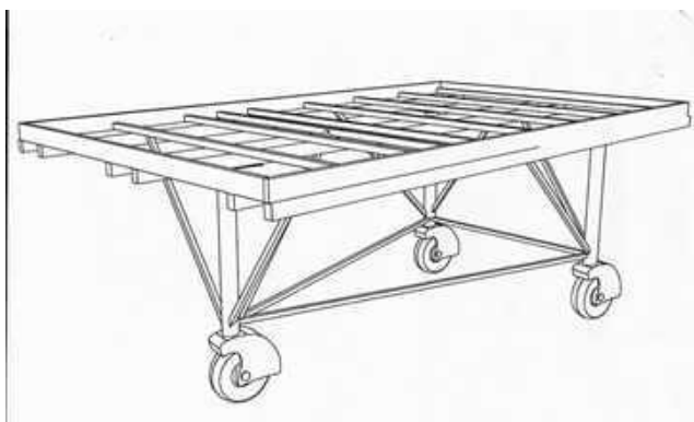
Boceto de estructura metálica con ruedas giratorias, para la última cena.
